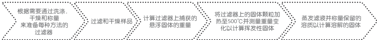
图1. 采用基于过滤的方法进行总固体分析流程
